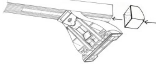
Inserire l'avanzo del metro tagliato (M1b per la barra anteriore ed M2b per la barra posteriore) per coprire la cava scoperta.
