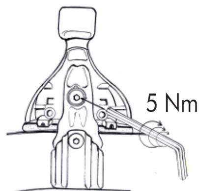
Stringere la vite superiore fino ad accompagnare la parte inferiore della ganascina al tetto. Stringere con forza la vite inferiore. Stringere con forza la vite superiore facendo **ATTENZIONE** a non spostare la centratura delle barre. Per ottenere il risultato corretto stringere le viti alternando il lato destro al lato sinistro in maniera uniforme.
