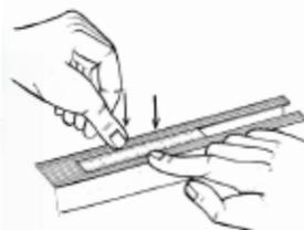
Inserire il metro tagliato in misura M1 nelle 2 cave della barra anteriore, portandolo fine a fine corsa. Ripetere l'operazione per la barra posteriore con i metri tagliati in misura M2.
