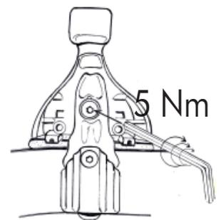
Stringere la vite superiore fino ad accompagnare la parte inferiore della ganascina al tetto. Stringere la vite inferiore arrivando a fine corsa. Stringere con forza la vite di congiunzione della ganascia. Stringere con forza la vite superiore facendo **ATTENZIONE** a non spostare la centratura delle barre. Per ottenere il risultato corretto stringere le viti alternando il lato destro al lato sinistro in maniera uniforme.
