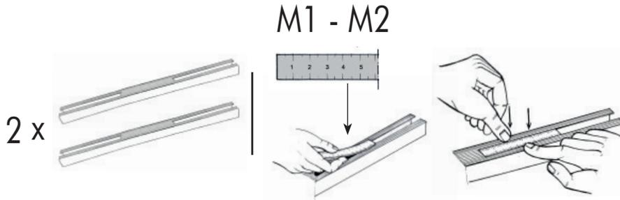
Inserire il metro tagliato in misura M1 nelle 2 cave della barra anteriore, portandolo fine a fine corsa.
