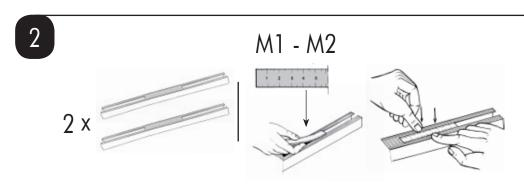
Inserire il metro tagliato in misura M1 nelle 2 cave della barra anteriore, portandolo fine a fine corsa.
