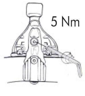
Stringere la vite superiore fino ad accompagnare la parte inferiore della ganascina al tetto. Stringere la vite inferiore arrivando a fine corsa. Stringere con forza la vite di congiunzione della ganascia. Stringere con forza la vite superiore facendo **ATTENZIONE** a non spostare la centratura delle barre. Per ottenere il risultato corretto stringere le viti alternando il lato destro al lato sinistro in maniera uniforme.
