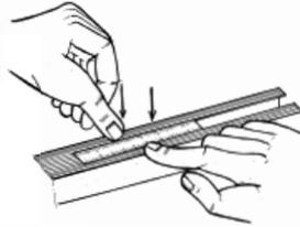
Inserire il metro tagliato in misura M1 nelle 2 cave della barra anteriore, portandolo fine a fine corsa.
