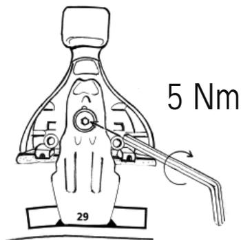
Stringere con forza la vite facendo **ATTENZIONE** a non spostare la centratura delle barre. Per ottenere il risultato corretto stringere le viti alternando il lato destro al lato sinistro in maniera uniforme.
