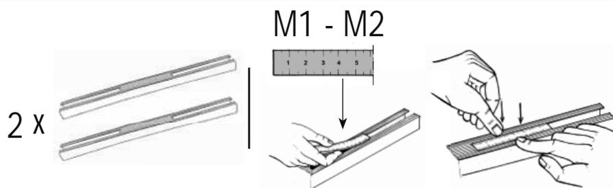
Inserire il metro tagliato in misura M1 nelle 2 cave della barra anteriore, portandolo fine a fine corsa.
