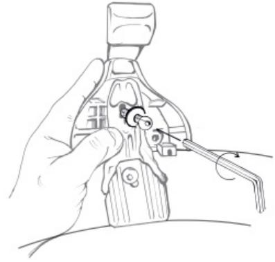
Posizionare la barra anteriore e la barra posteriore sul tetto dell'autovettura. Fissare le ganascine ai 4 piedi facendo **ATTENZIONE** a non stringere completamente la vite.
