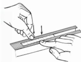
Inserire il metro tagliato in misura M1 nelle 2 cave della barra anteriore, portandolo fine a fine corsa.
