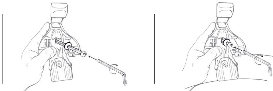
Posizionare la barra anteriore e la barra posteriore sul tetto dell'autovettura. Fissare le ganascine ai 4 piedi facendo **ATTENZIONE** a non stringere completamente la vite.
