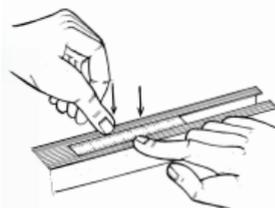
Inserire il metro tagliato in misura M1 nelle 2 cavi della barra anteriore, portandolo fine a fine corsa. Ripetere l'operazione per la barra posteriore con i metri tagliati in misura M2.
