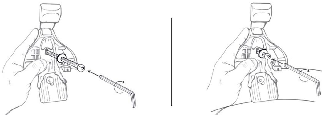
Posizionare la barra anteriore e la barra posteriore sul tetto dell'autovettura. Fissare le ganasce ai 4 piedi facendo **ATTENZIONE** a non stringere completamente la vite.
