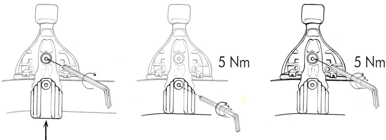
Stringere la vite superiore fino ad accompagnare la parte inferiore della ganasca al tetto. Stringere con forza la vite inferiore. Stringere con forza la vite superiore facendo **ATTENZIONE** a non spostare la centratura delle barre. Per ottenere il risultato corretto stringere le viti alternando il lato destro al lato sinistro in maniera uniforme.
