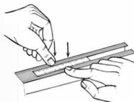
Inserire il metro tagliato in misura M1 nelle 2 cave della barra anteriore, portandolo fine a fine corsa. Ripetere l'operazione per la barra posteriore con i metri tagliati in misura M2.
